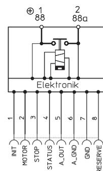
Die Elektronik des Relais misst den Hauptstrom galvanisch getrennt. Beim Überschreiten der von ihnen vorgegebenen Stromschwellen schaltet das Relais ab und bleibt bis zum Zurücksetzen des INIT-Eingangs oder der Versorgungsspannung abgeschaltet. Bei erneutem Einschalten wird das Relais wieder aktiviert.
